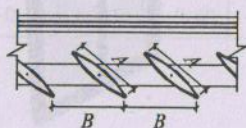
图 5.0.2-5 竖百叶挡板式外遮阳
